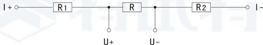
上图中 $R_1$ 、 $R_2$ 为引线电阻及接触电阻， $R$ 才是被试品的电阻，为了准确测量 $R$ ，排除 $R_1$ 、 $R_2$ 的影响，只能采用四端子接法，仪器会根据公式 $R=U_R/I_R$ ，自动计算出准确的 $R$ 值。
