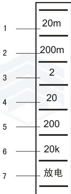
(1) 量程为 $20\text{m}\Omega$ ,被试品阻值为 $1\mu\Omega\sim 20\text{m}\Omega$ 之间按此键。
